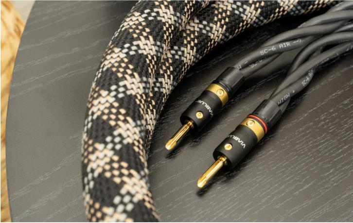
Als Kontaktstifte kommen vergoldete Hohlbananenkontakte zum Zuge. Sie ermöglichen einen hohen Anpressdruck und bieten dank der weichen Oberfläche eine große Kontaktfläche. Die vorderen Inbus-Madenschrauben deuten bereits an, dass die Steckerstifte leicht und ohne Lötarbeit austauschbar sind. Die hinteren Schrauben fixieren das Kabel im Stecker und dienen so als Zugentlastung.
