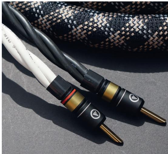
Ainsi, le câble n'est pas capacitif et s'adapte facilement à tout environnement. Le système Air Pipe empêche également les champs magnétiques indésirables. Il est composé de deux groupes de six conducteurs composés de 19 brins de cuivre OFC plaqués argent. Viennent ensuite trois boucliers dorés ALU-PET et trois boucliers spiralés en cuivre OFC étamé à contre-rotation.
